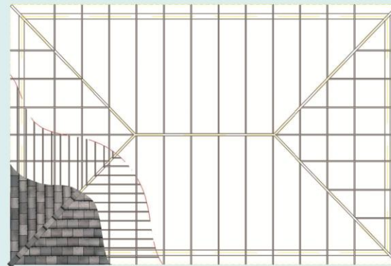
Contoh Penempatan Kuda - Kuda Rangka Atap KARANG PILANG TRUSS.
